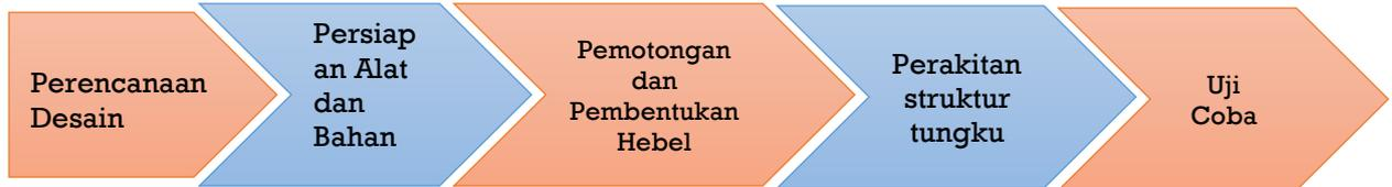
Gambar 4. Tahapan Pembuatan Tungku Pembakaran Rocket Stove
